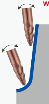
工具軸を傾斜し加工することでパレルR部を使用し、勾配面がピッチを大きく加工できます。更に先端R部を使用することで加工段差の少ない切削が可能です。
